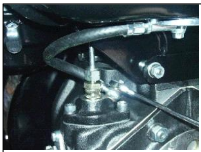
10. Slăbiți șurubul(bușonul) pt. purjare și rotiți arbirele cotit manual.
