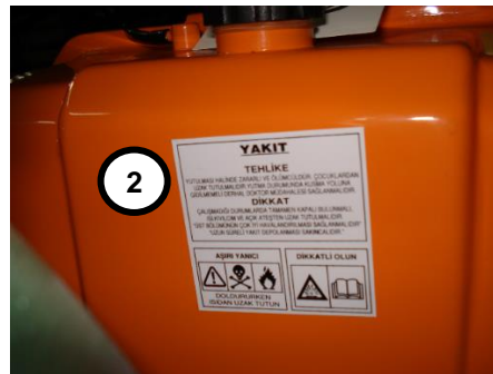
[2] Pe rezervorul de combustibil al motorului: Etichetă de siguranță pentru: Combustibilul este inflamabil, Combustibilul este toxic.
