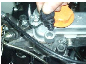
13. Extrageți bușonul pt. pornire la temperaturi joase.
